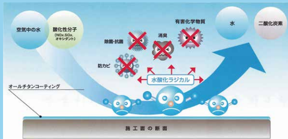
オールチタンコーティング分解原理イメージ図
